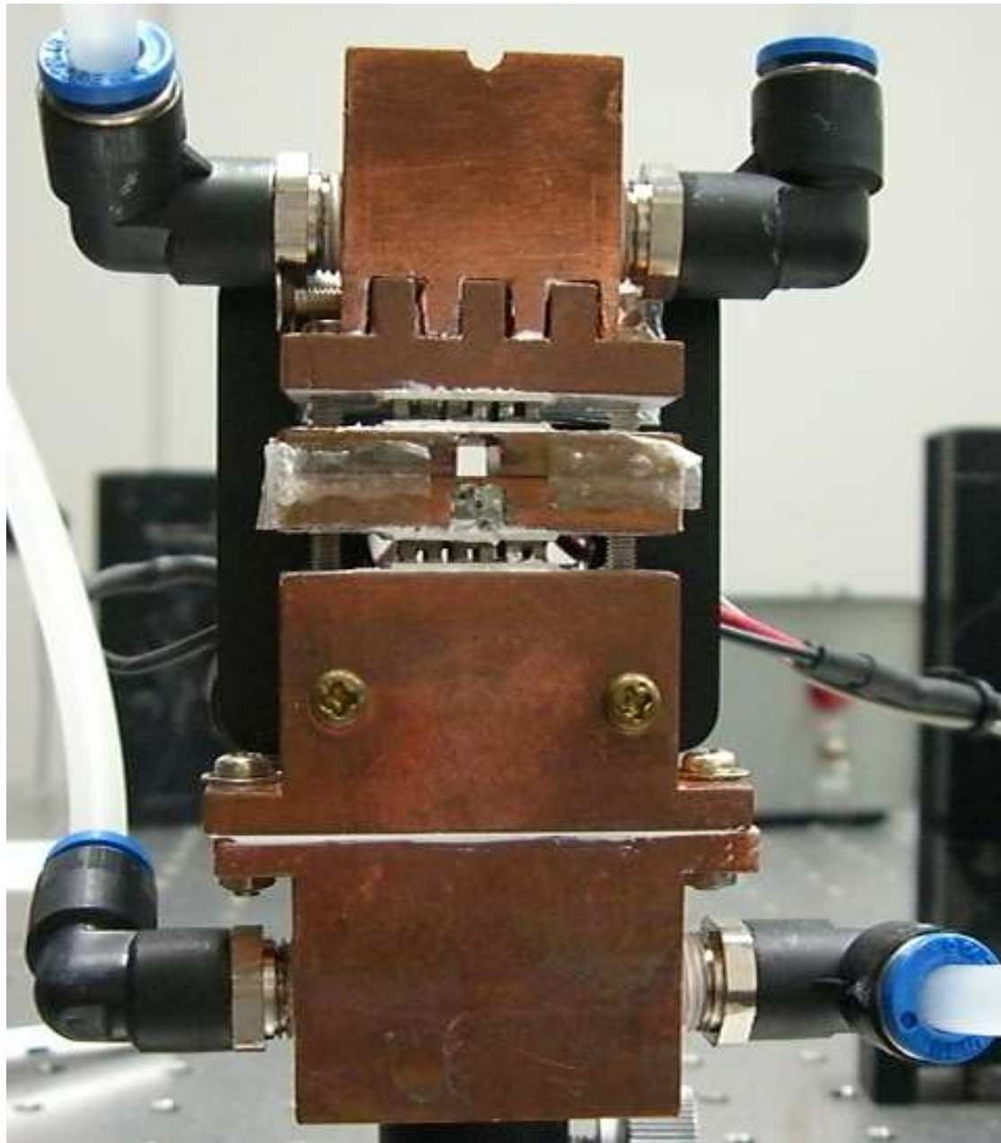
図3 温度許容幅実測に用いた結晶ホルダ写真.
